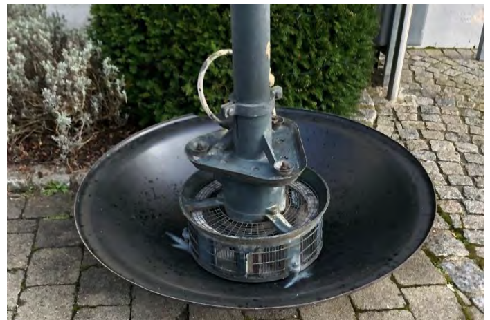
Alte abgebaute Sirene
