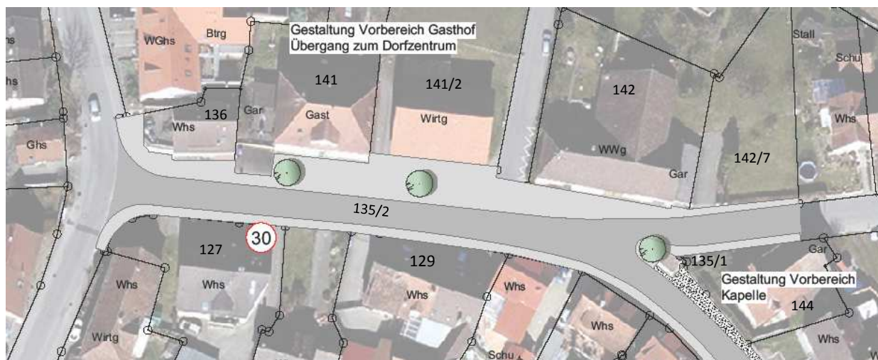
Abb. 22: Planausschnitt – Ortsmitte Böhringer Straße, Baumpflanzungen + Gehwegpflasterung
